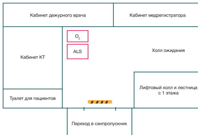
Рис. 2. Зонирование этажа с компьютерным томографом. О 2 — источник кислорода, ALS — реанимационная тележка. При возможности, необходимо предусмотреть туалет для пациентов в красной зоне
