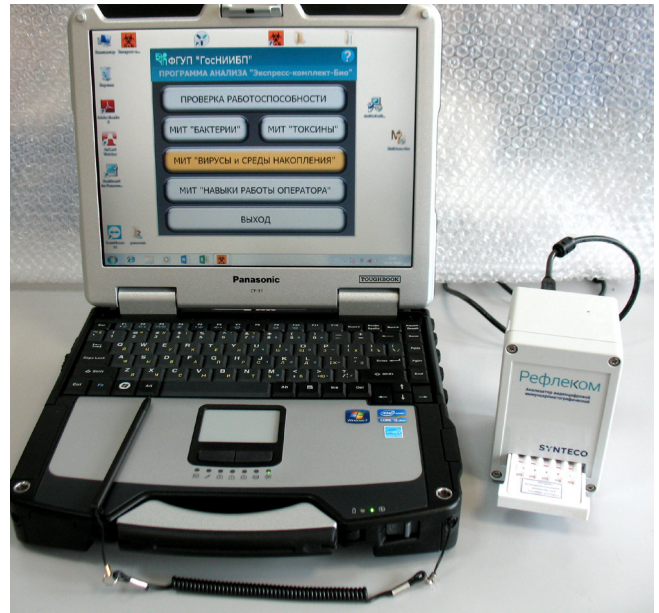
Рис. 3. Внешний вид рефлектометрического устройства комплекта ЭкБ
