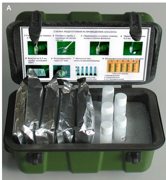
Рис. 4. Внешний вид комплекта ЭкБ-01. А. Комплект с открытой крышкой. Б. Крепление комплекта к обмундированию оператора
