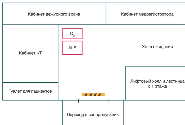
Рис. 2. Зонирование этажа с компьютерным томографом. O<sub>2</sub> — источник кислорода, ALS — реанимационная тележка. При возможности, необходимо предусмотреть туалет для пациентов в красной зоне
