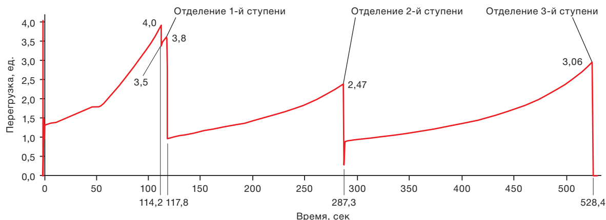
Рис. 1. Типовой профиль перегрузок при выведении ТПК «Союз» на околоземную орбиту
