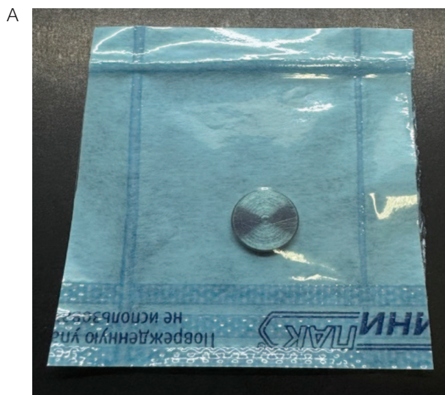
Рис. 2. Подготовка титановых дисков для газодинамической обработки: А — индивидуальная упаковка контаминированного титанового диска в крафт-пакет; Б — размещение упакованного диска в пробирке с раствором окислителя для проведения обработки по режимам CDHP или CDPAA
