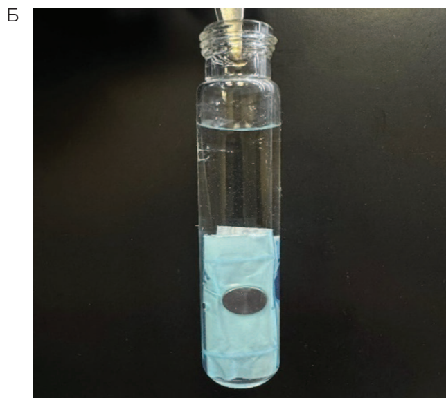
Рис. 2. Подготовка титановых дисков для газодинамической обработки: А — индивидуальная упаковка контаминированного титанового диска в крафт-пакет; Б — размещение упакованного диска в пробирке с раствором окислителя для проведения обработки по режимам CDHP или CDPAA
