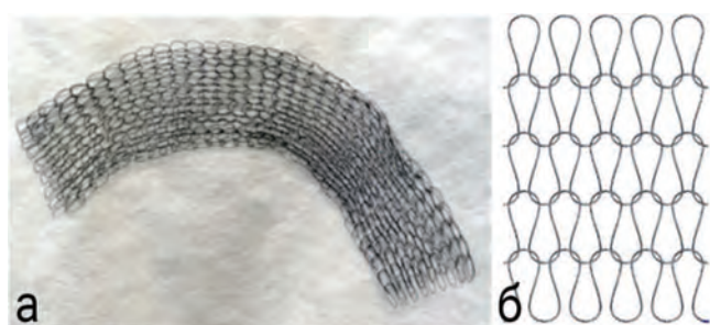
Рис. 1. Металлотрикотаж из никелид-титановой проволоки: а — общий вид двухслойной ленты; б — геометрическая модель однослойного образца
